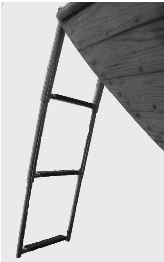
Den aktuella stegen är lätt, inget hinder för kappsegling. Den monteras på akterdäck och fälls ner i vattnet. Den förlängs teleskopiskt till lagom längd. Fungerar utmärkt att klättra ombord på själv. Har nu seglat en halv säsong med den, som väl är har jag inte behövt använda den som räddningsstege. Stegen finns att köpa i bl.a. välsorterade båtillbehörsaffärer. Priset ligger omkring 600-700 kr. Kan verkligen rekommenderas.
